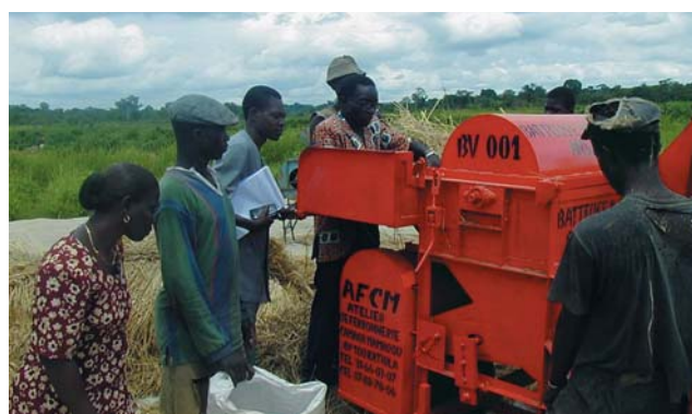
Heureux propriétaire d'ANWAR BV 001, Lamine Coulibaly, exploite la batteuse-vanneuse pour les paysans dans le périmètre de Lope
